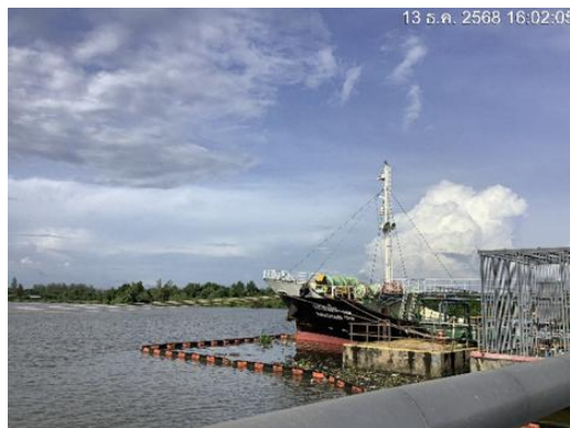
ภาพที่ 5 การล้อมฟันทัน (Boom) รอบลำเรือบรรทุก
